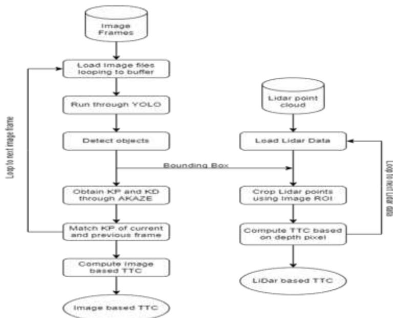
Fig. 4. Workflow Diagram
